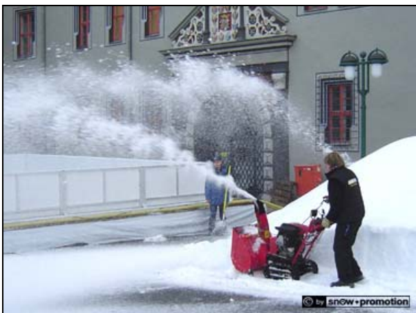
Für die Verteilung großer Schneemengen aus der Vorproduktion eignen sich Schneefräsen bestens.
